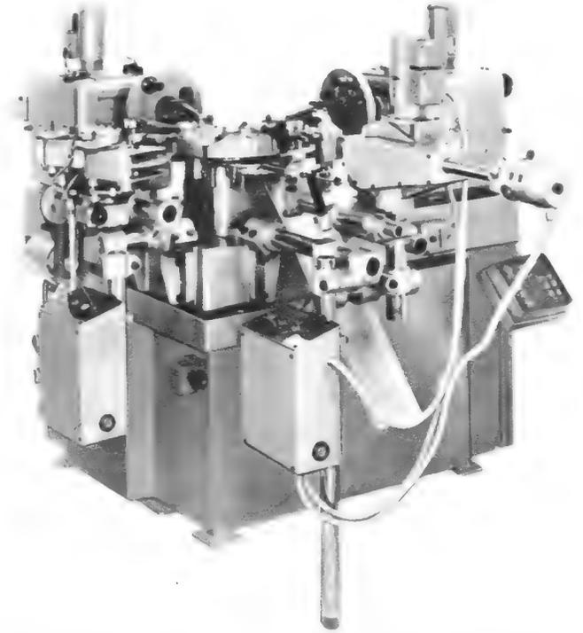
Die Einsatzmöglichkeiten der Aumann-Folgewickelautomaten sind vielseitig. Durch die Ausrüstung mit Zusatzstationen und Hilfsaggregaten kann die Standard-Maschine bis zur vollautomatischen Fertigung von Spulen unterschiedlicher Bauart erweitert werden.
