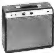
**NORIS-Kofferverstärker GV 5**. Ein Verstärker nach seiner neuen Konzeption, Sprechleistung 5 W, ausreichend für kleinere Bars und Gaststätten, Frequenzgang: 100—10 000 Hz, speziell für elektrische Gitarren geeignet. Lautsprecher 6,5 Guitar-Stringtype, Rö.: 2 x 6 AV 6, 8 AR 5, 5 MK 9, Maße: 325 x 280 x 150 mm, Gew. 5,6 kg. Dieser Verstärker eignet sich auch zur Schallplattenwiedergabe **119.50**
