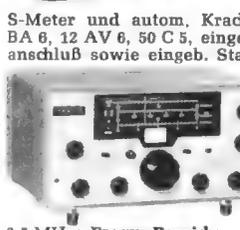
**STAR SR 550 Doppelsuper:** 1. ZF: 1600 kHz, 2. ZF: 55 kHz, Bandpaßfilter mit 4 Bandbreiten: 0,5—1,2—2,5—4 kHz. Produktdetektor für SSB, eingeb. Eichmarkengenerator
