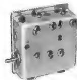
**UHF-Converter-Tuner** zum Einbau in FS-Geräte der deutschen, französischen und US-Norm. Er dient zum Empfang von UHF-Sendern im Bereich von 470-860 MHz. Die Abstimmung erfolgt kapazitiv und nahezu frequenzlinear. Untersetzer Antrieb 1:6,5. Antenneneingang: 240 Ω. Antennenausgang: 240 Ω (Kanal 3 oder 4, 54-88 MHz) 36.-
