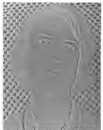
sind jetzt entgegengesetzt gleich und heben sich auf. Dieses Differenzbildsignal kann direkt ohne weitere Maßnahmen zum ursprünglichen Videosignal in geeigneter Amplitude addiert werden, um die Bildschärfe in allseitiger Richtung zu verbessern, ohne daß der Pegel des Bildsignals in großflächigen Strukturen verändert wird.
