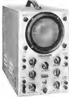
12,5-cm-Bildröhre mit Flußlichtrasterscheibe und kontinuierlicher Helligkeitsregelung, Strahlverschiebung horizontal und vertikal, Rücklaufaustastung, Helligkeitsmodulationsanschluß, Eichspannung, 50 Hz und Sägezahnangang. Technische Daten: Vertikal: Gleichspannungs-Gegentaktverstärker 0-5 MHz (verwendbar bis 10 MHz) 10 mV/cm, 4fach Frequenzkomp.
